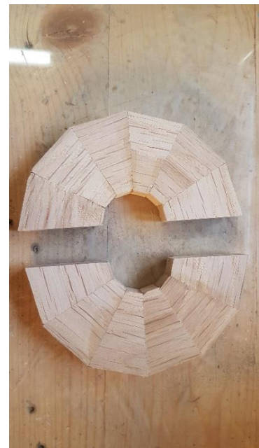
Figuur 7: beide helften droog en klaar voor te schuren en te lijmen
