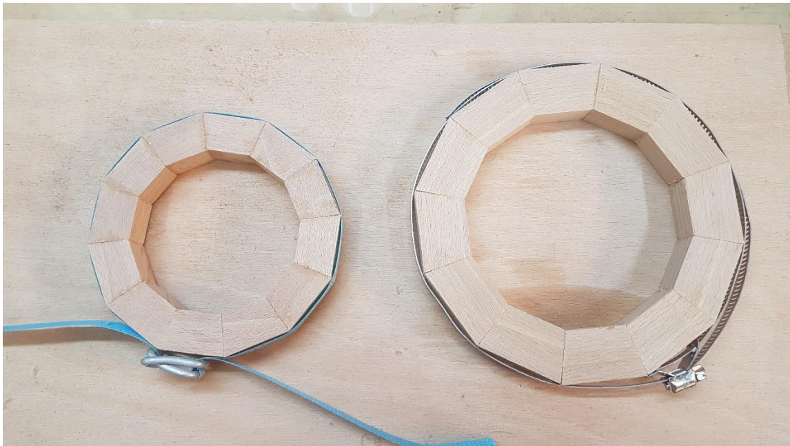
Figuur 5: het klemmen van segmenten met behulp van een metalen of kunststof band.
