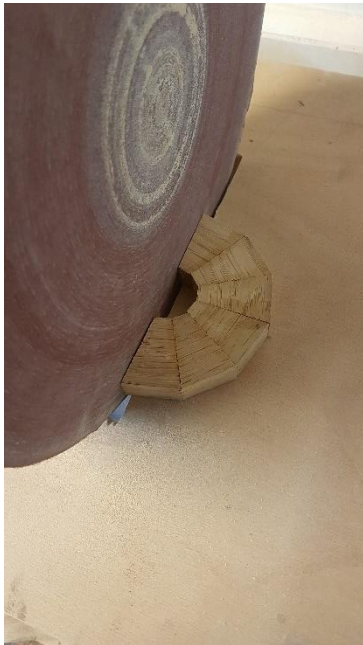
Figuur 9: vlakschuren van lijmvlak beide helften van de ring
