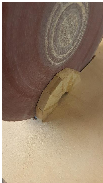
Figuur 8: door de ring even te schuren gaat op de vlakke zijde bekomt men een beter resultaat
