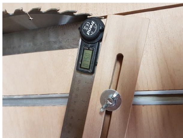
Figuur 2: de digitale hoekmeter
